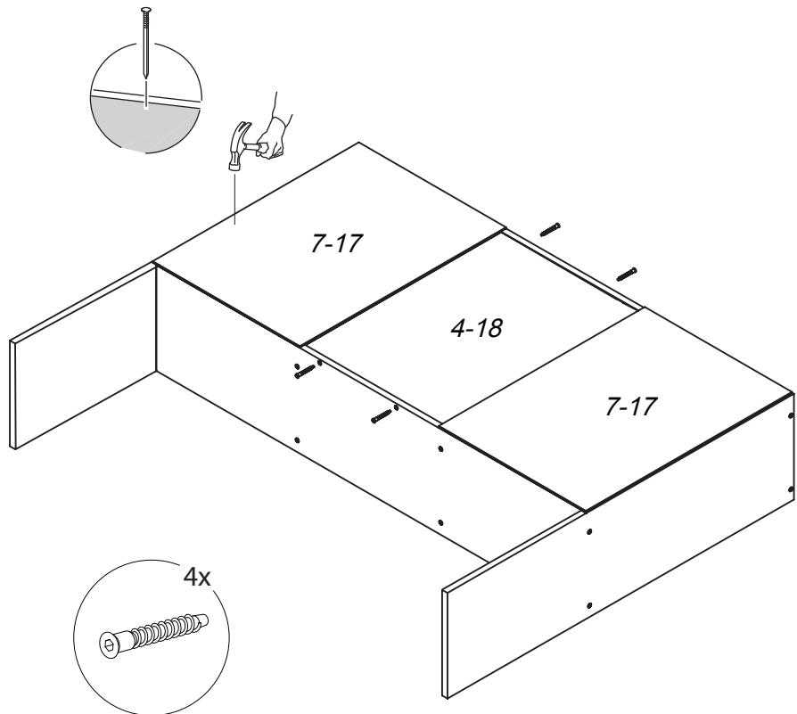
*2. Сборка каркаса шкафа.*
