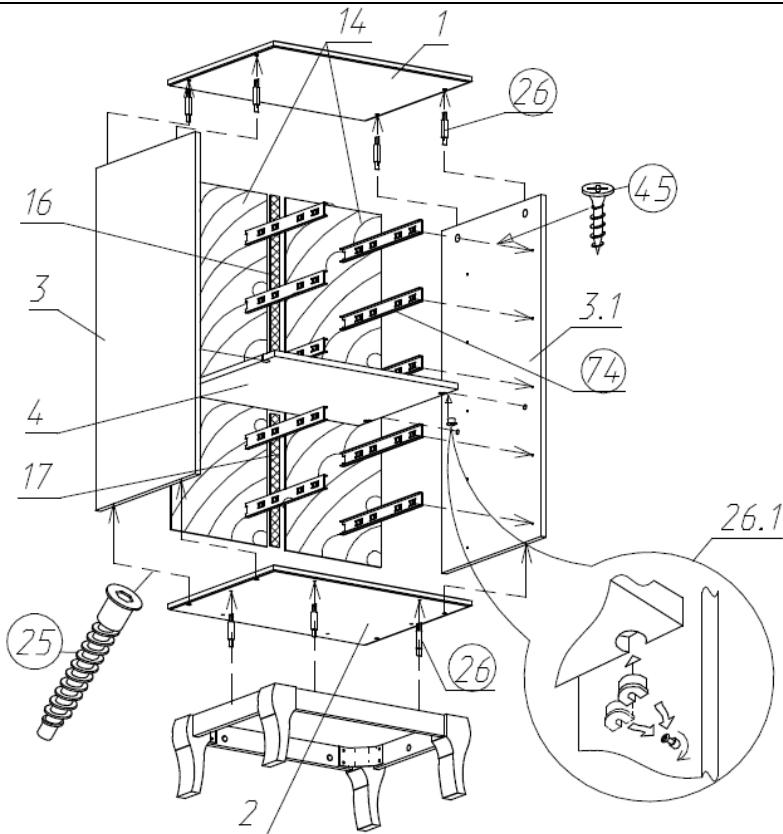
Схема соединения бруском соединительным
