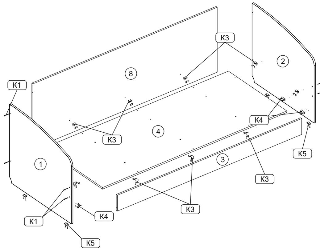
Схема 2. Сборка выдвижного спального места
