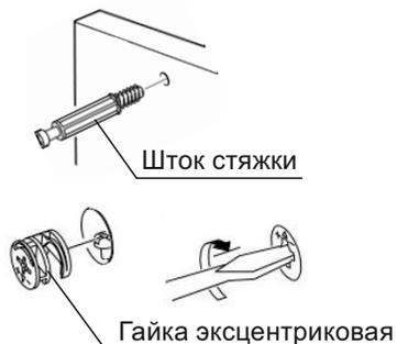
Схема 4. Установка уголка-стяжки
