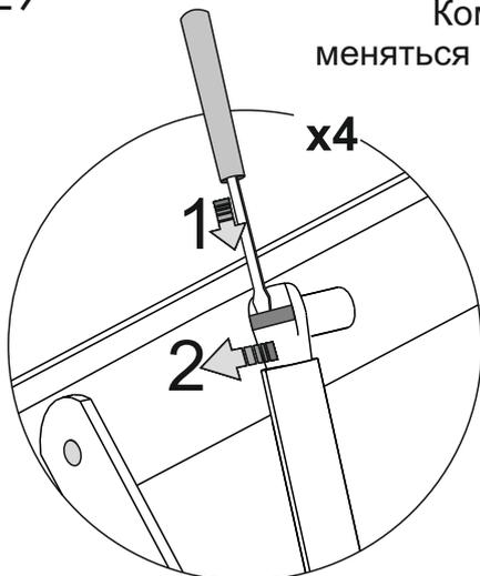
Для снятия газового амортизатора:
