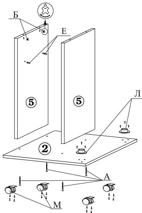
1.2. С верхней стороны основания закрепите два фланца (поз.Л). В отверстия боковин (дет.№5) установите эксцентрики (поз.Б).
