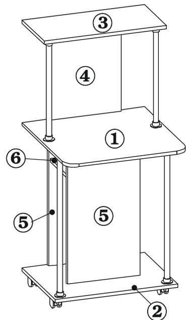
1.1. С нижней стороны основания (дет.№2) установите мебельные колеса (поз.М). В боковины (дет.№5) закрутите винчиваемые дюбели (поз.Е). Закрепите детали №5 на основании (дет.№2). Закрепите винтовыми стяжками (поз.А).
