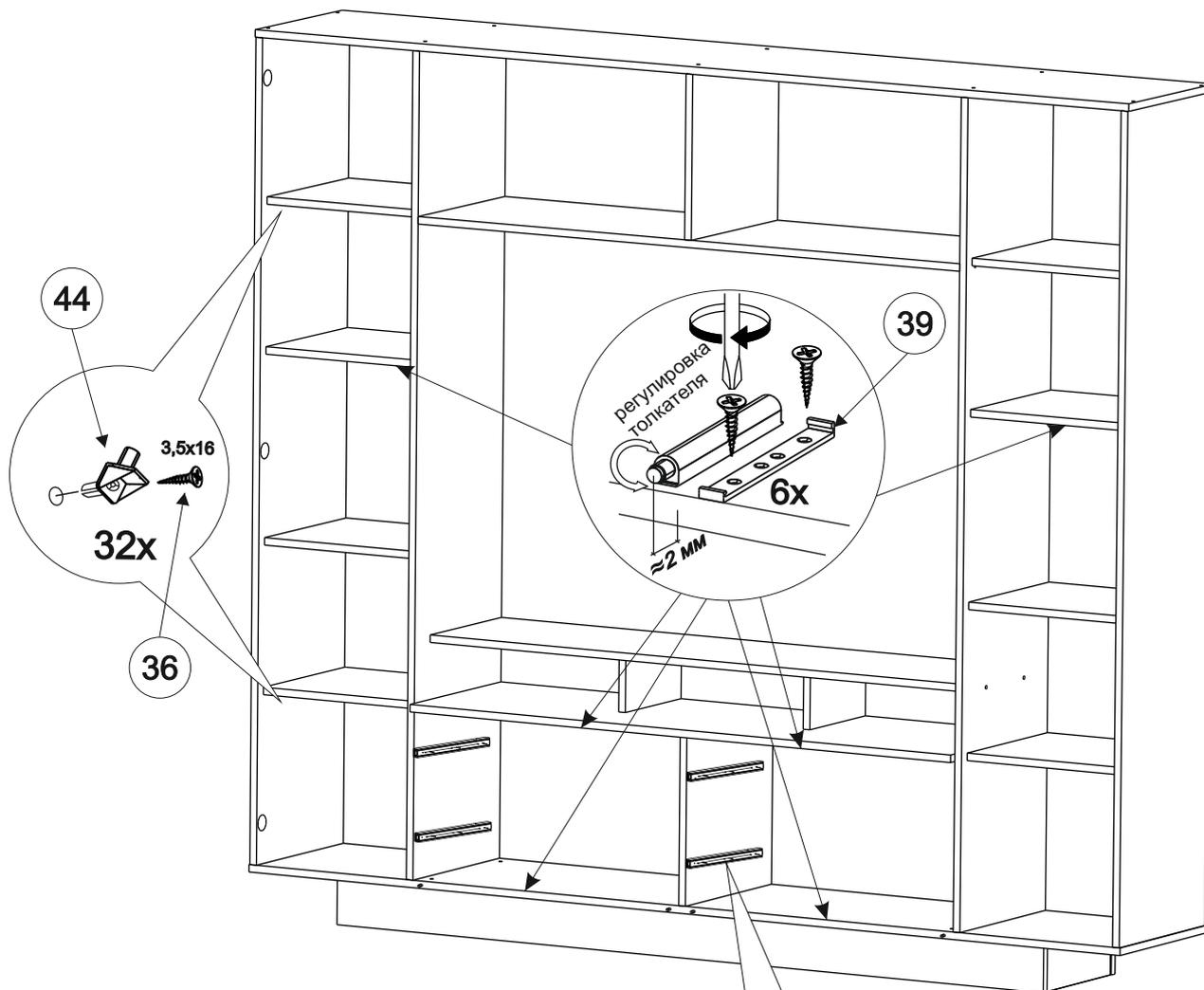
Порядок монтажа шариковых направляющих полного выдвижения
