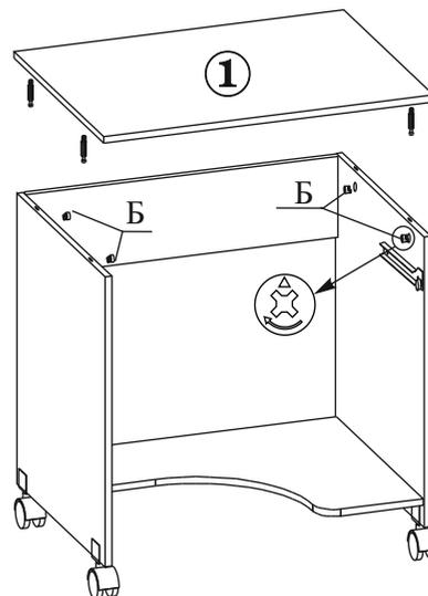
3.4. Установите выкатную полку дет.№6 на направляющие, закрепленные на боковых стенках №2 и №3. Для этого наклоните ее, и заведите ролики на выкатной полке за ролики на направляющих установленных на боковинах.
