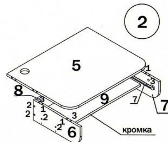
3. Забить шканты (1) в торцевые отверстия столешницы 5. Соединить элементы стола собранные в п. 1 и п. 2. Для удобства соединения этих элементов следует несколько ослабить евровинты (2) обозначенные "M".
