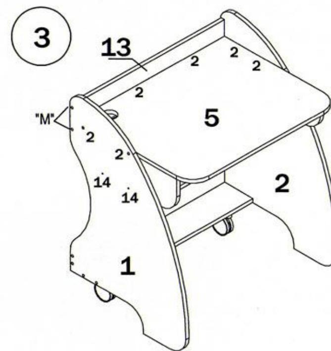
После сборки стола зафиксировать столешницу к боковинам 1, 2 и царги верхней 13 евровинтами (2). Затянуть винты (2) обозначенные "M". Дополнительную фиксацию боковин 1 и 2 со стойками 6 и 7 произвести при помощи межсекционных стяжек (14)..
