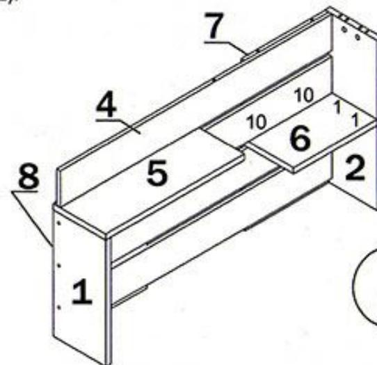
Забить шканты (1) в полку 6 и соединить ее с боковиной 2. Фиксацию полки 6 к стенке задней 7 произвести при помощи евроинтов (10).
