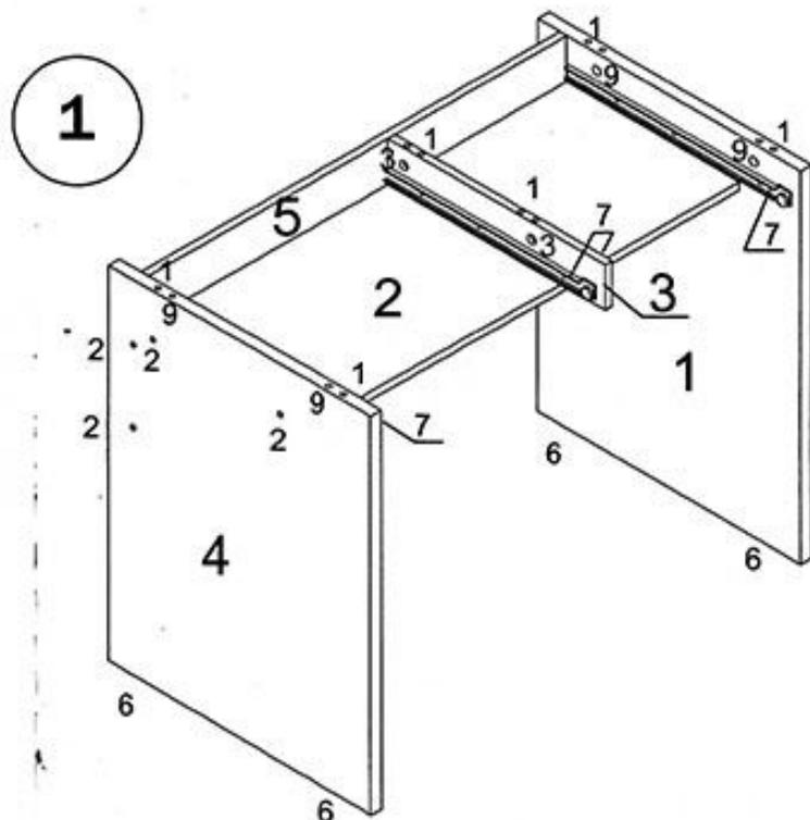
Соединить боковины 1 и 4 с деталями 2 и 5 при помощи шкантов (1) и евроинтов (2). Присоединить стойку 3 к полке 2 при помощи шкантов (1) и евроинтов (15)
