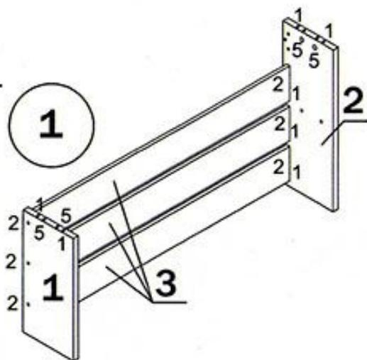
2. Закрутить в муфты полки 5 дюбеля стяжек-растекс (4) и соединить ее с боковиной 1. Фиксацию стяжек-растекс (5) произвести путем поворота их по часовой стрелке.
