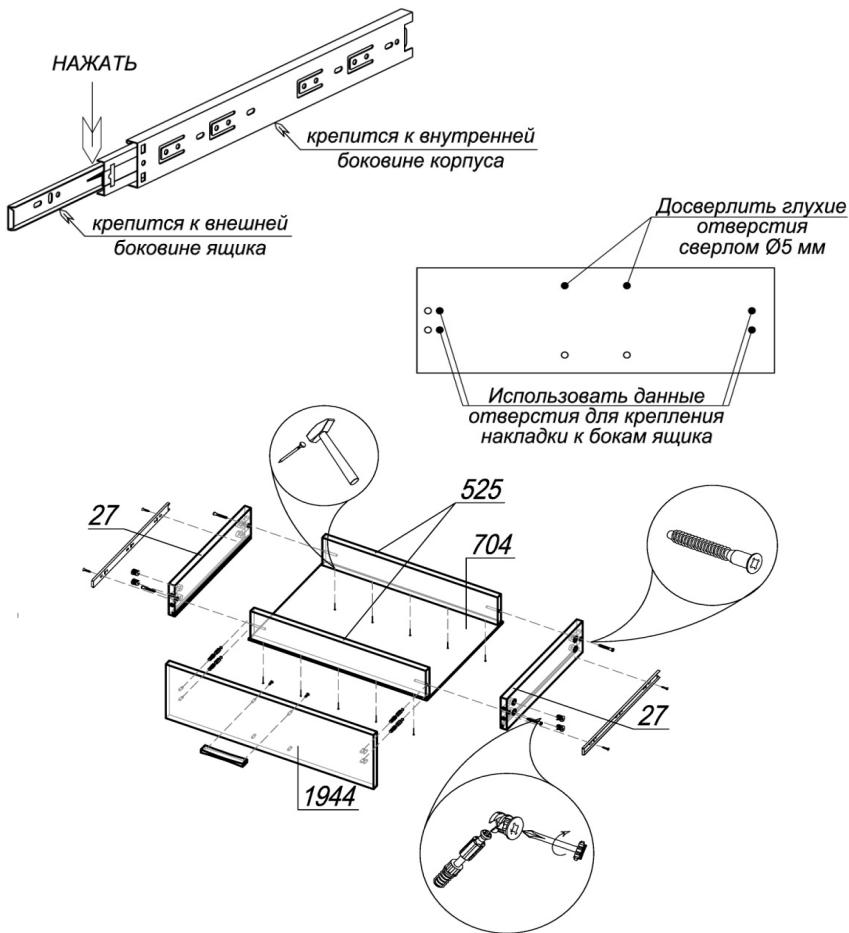
**ШАГ 1.** Перед началом сборки изделия подготавьте направляющие полного выдвижения, разобрав их на две части. Для этого вытянуть внутреннюю планку до предела, нажать на деблокировочный рычаг и снять внутреннюю подвижную планку направляющих. Внешняя неподвижная планка крепится к внутреннему боку корпуса, внутренняя подвижная - к внешнему боку ящика.
