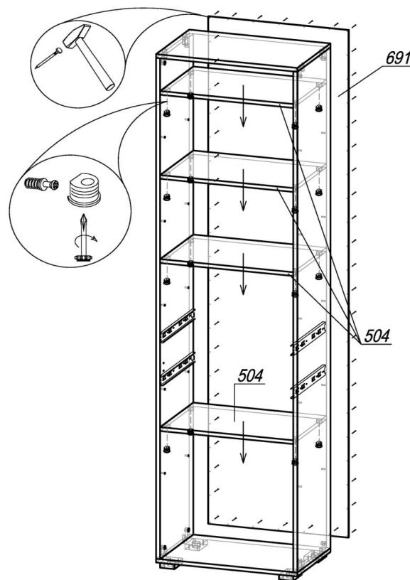
ШАГ 3. В полки 504 установить стяжку-полкодержатель (по 4 шт в деталь), вставить полки в шкаф и закрепить дюбели, затянуть стяжки. Далее сборка производится лицевой стороной вниз. Проверив рулеткой или рейкой равенство диагоналей, прибить гвоздями 2x20 заднюю стенку ЛДВП 691. Поднять шкаф и установить на место.
