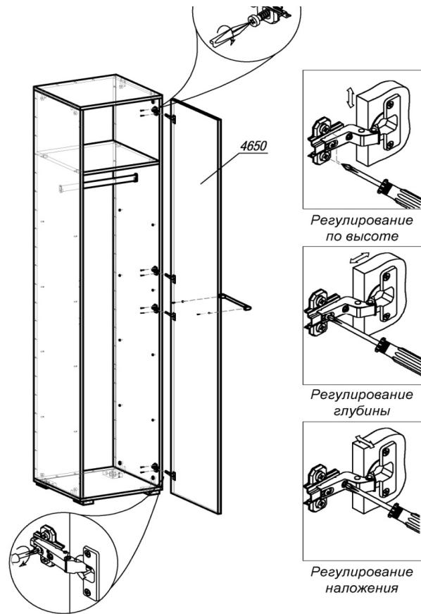
**ШАГ 4.** Разобрать петлю для накладной двери на две части (петля и ответная планка петли). Вторую часть петли (ответная планка) прикрепить шурупами 4x16 к боку 4611. Подготовить створку 4650, закрепив первую часть петли шурупами. Навесить створку 4650 на накладные петли. Привернуть ручку винтами 4x25. Закрыть открытые отверстия и эксцентрики соответствующими заглушками. Убедитесь, что шкаф стоит ровно. При необходимости выровняйте его с помощью регулировки опоры.
