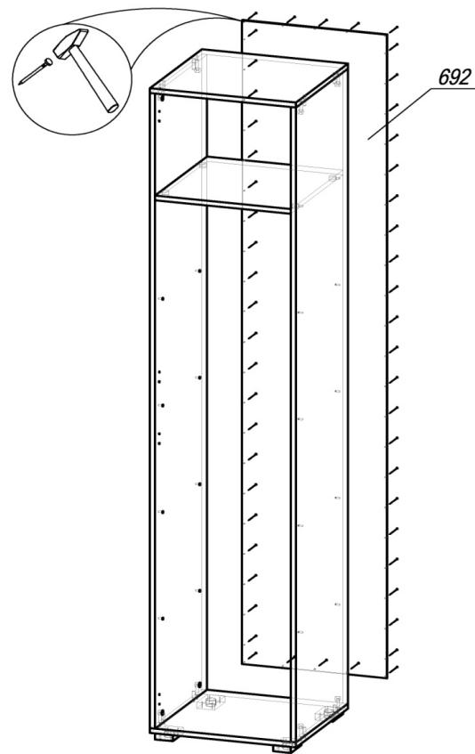
ШАГ 2. Сборка производится лицевой стороной вниз. Проверив рулеткой или рейкой равенство диагоналей, прибить гвоздями 2х20 заднюю стенку ЛДВП 692. Поднять шкаф и установить его на место.
