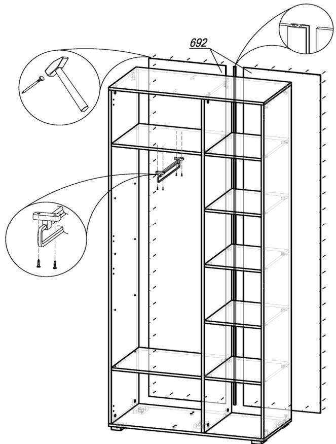
**ШАГ 3.** Сборка производится лицевой стороной вниз. Проверив рулеткой или рейкой равенство диагоналей, прибить гвоздями 2x20 заднюю стенку ЛДВП 692 (1 деталь). Установить соединительный брус, следом задвинуть 2-ую деталь ЛДВП 692 и прибить гвоздями. Поднять шкаф и установить его на место. Шурупами 4x16 привернуть выдвижную штангу.
