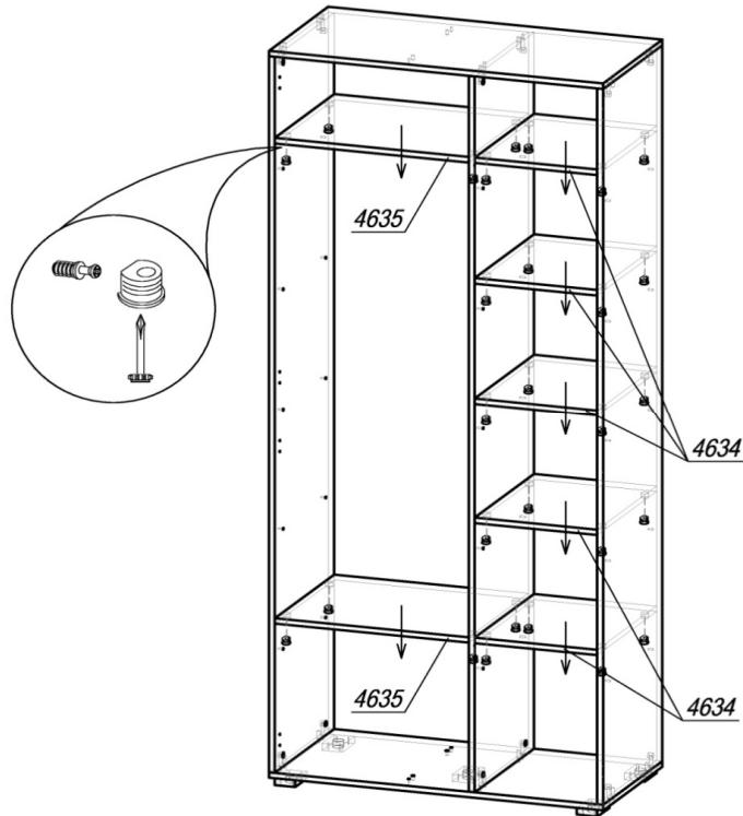
ШАГ 2. В полки 4634 и 4635 установить стяжку-полкодержатель (по 4 шт на каждую), вставить полки в шкаф и закрепить дюбели, затянув стяжки.
