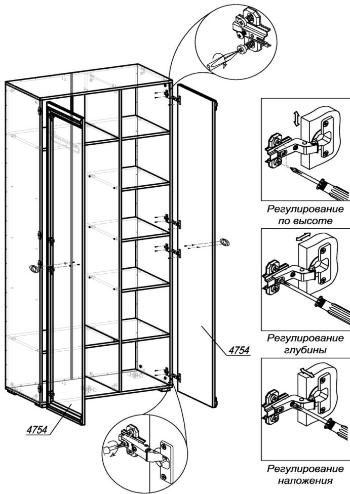
**ШАГ 4.** Разобрать петлю для накладной двери на две части (петля и ответная планка петли). Закрепить первую часть петли шурупами 4x16 на створках 4754. Вторую часть петли (ответная планка) прикрепить шурупами 4x16 к бокам 4611. Навесить створки на накладные петли. Привернуть ручки винтами. Закрыть эксцентрики и открытые отверстия соответствующими заглушками. Убедитесь, что шкаф стоит ровно. При необходимости выровняйте его с помощью регулировки опоры.
