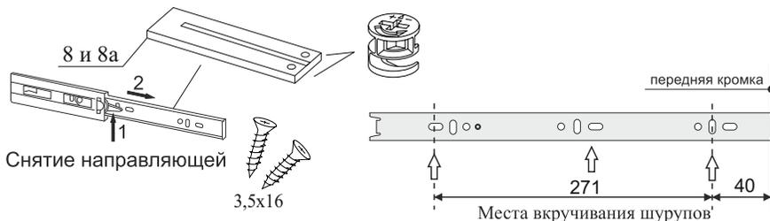
**ВНИМАНИЕ!** В зависимости от производителя направляющих места вкручивания шурупов могут отличаться. Необходимо выровнять направляющие по краю детали.
