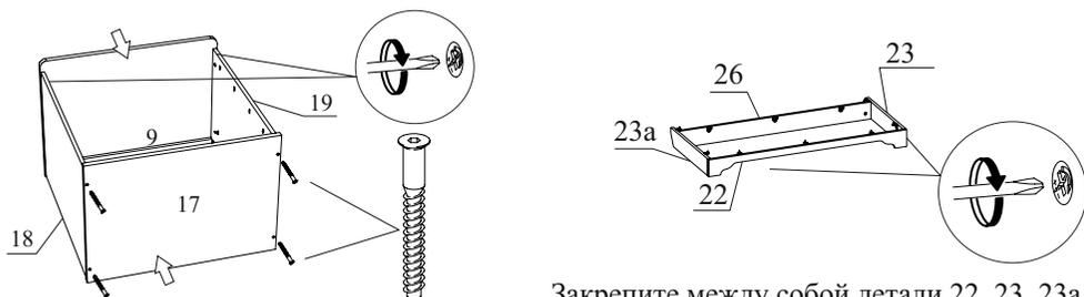
Закрепите деталь 9 к деталям 18 и 19, затяните эксцентрики.
