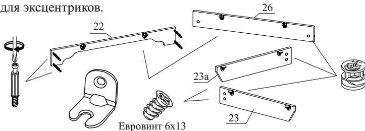
7.2. С помощью рычажка разделите направляющие, внешнюю часть закрепите с помощью шурупов 3,5x16 на детали 18 и 19. Вставьте эксцентрики в отверстия  $\phi 15 \times 13$ .
