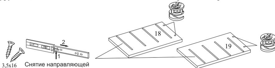
**ВНИМАНИЕ!** В зависимости от производителя направляющих места вкручивания шурупов могут отличаться. Необходимо выровнять направляющие по краю детали.
