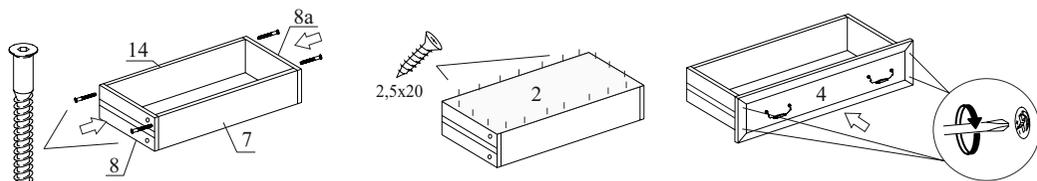
Закрепите детали 8, 8а, 14 и 7 с помощью евровинтов 7х50
