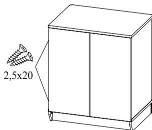
Установите комод вертикально. Выровняйте диагонали шкафа и закрепите задние ДВП стенки с помощью шурупов 2,5х20.
