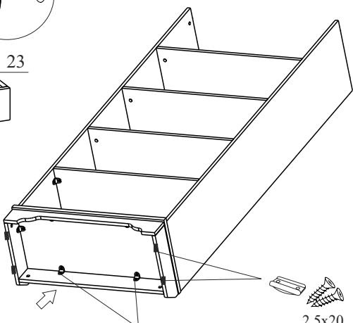
Закрепите между собой детали 22, 23, 23a и 26, затянув эксцентрики.
