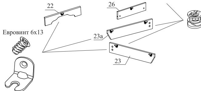
5.2. Установите на детали 18 и 19 дюбеля для эксцентрика. Вставьте эксцентрики в отверстия  $\phi 15 \times 13$ . С помощью рычажка разделите направляющие, внешнюю часть закрепите с помощью шурупов 3,5x16. Для пенала к детали 19 закрепите ответные планки петель с помощью шурупов 4x16.
