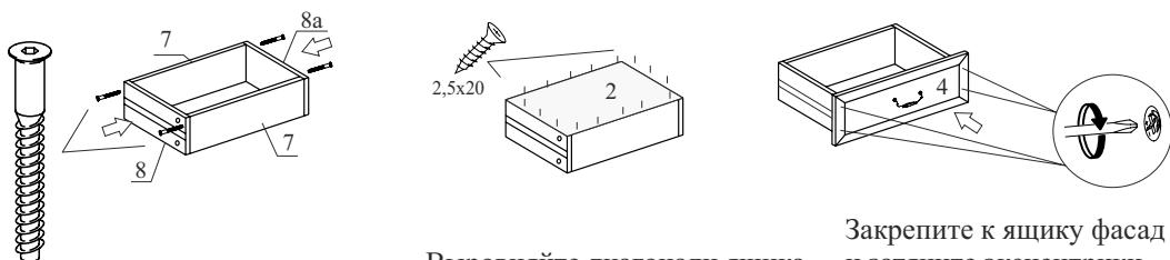
Закрепите детали 8, 8а и 7 с помощью евровинтов  $7 \times 50$
