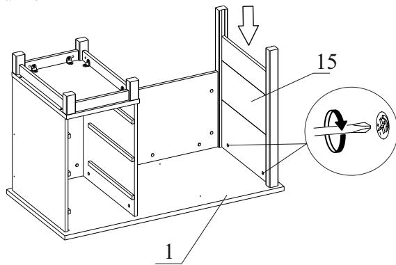
7.7. Аккуратно раздвинув опоры вставьте дет.25 и закрепите ее к опоре 17 винтом M6\*70 и стяжкой бочонок, а к опоре 16 стяжкой конической.
