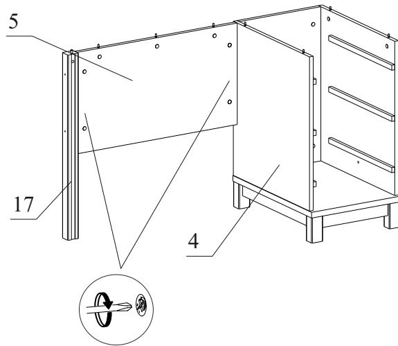
7.5. Закрепите получившуюся конструкцию к столешнице поз.1 эксцентриками, а дет.16 и 17 стяжкой конической.
