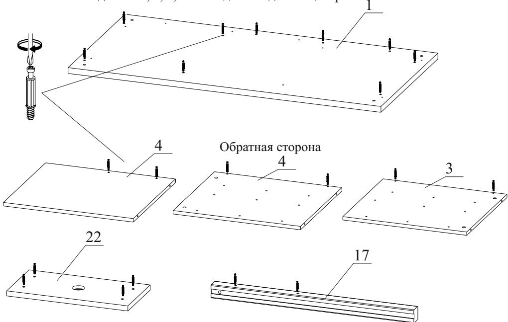
5.2. Установите на деталь 2 стяжки угловые с помощью евровинтов 6,3\*13.
