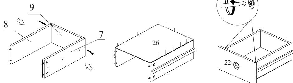
8.1. Закрепите детали 7, 8 и 9 с помощью евровинтов 7х50
