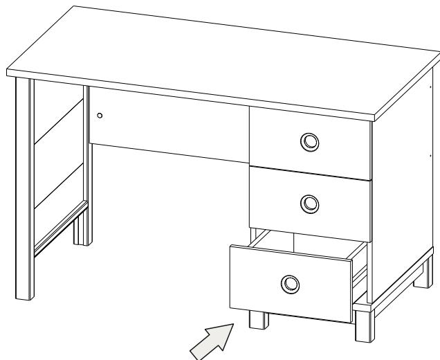
10. Установить пластмассовые заглушки на шляпки евровинтов и головки эксцентриков на видимых поверхностях изделия.
